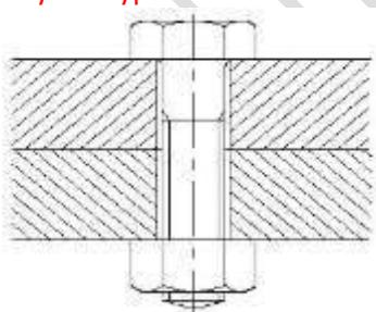
A. Bolt with clearance hole क्लीरेंस होल के साथ बोल्ट
